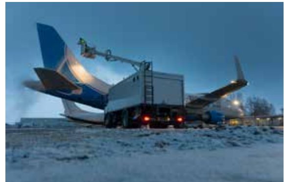
▲ Mit einem Alkohol-Wasser-Gemisch wird das Flugzeug enteist.
